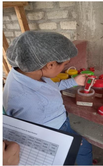
Tomando muestra de PH, conductividad, temperatura con el multiparámetro.
